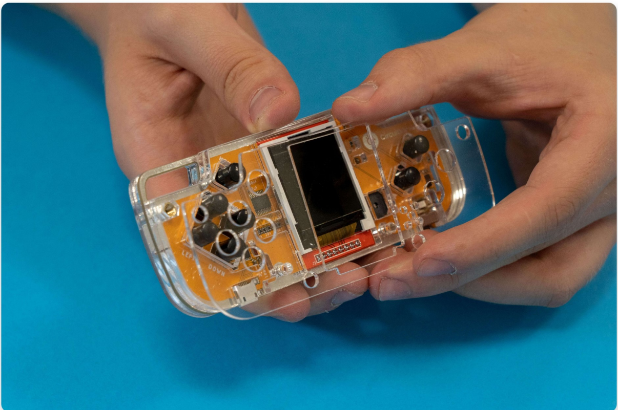
Het plaatsen van de bovenste laag - de laatste laag van de "sandwich"
