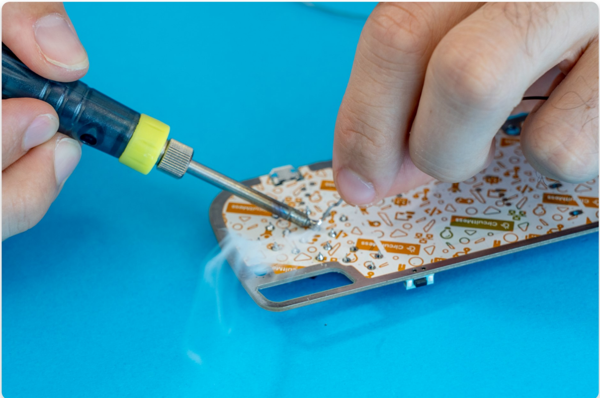
De rest van de knoppen solderen
