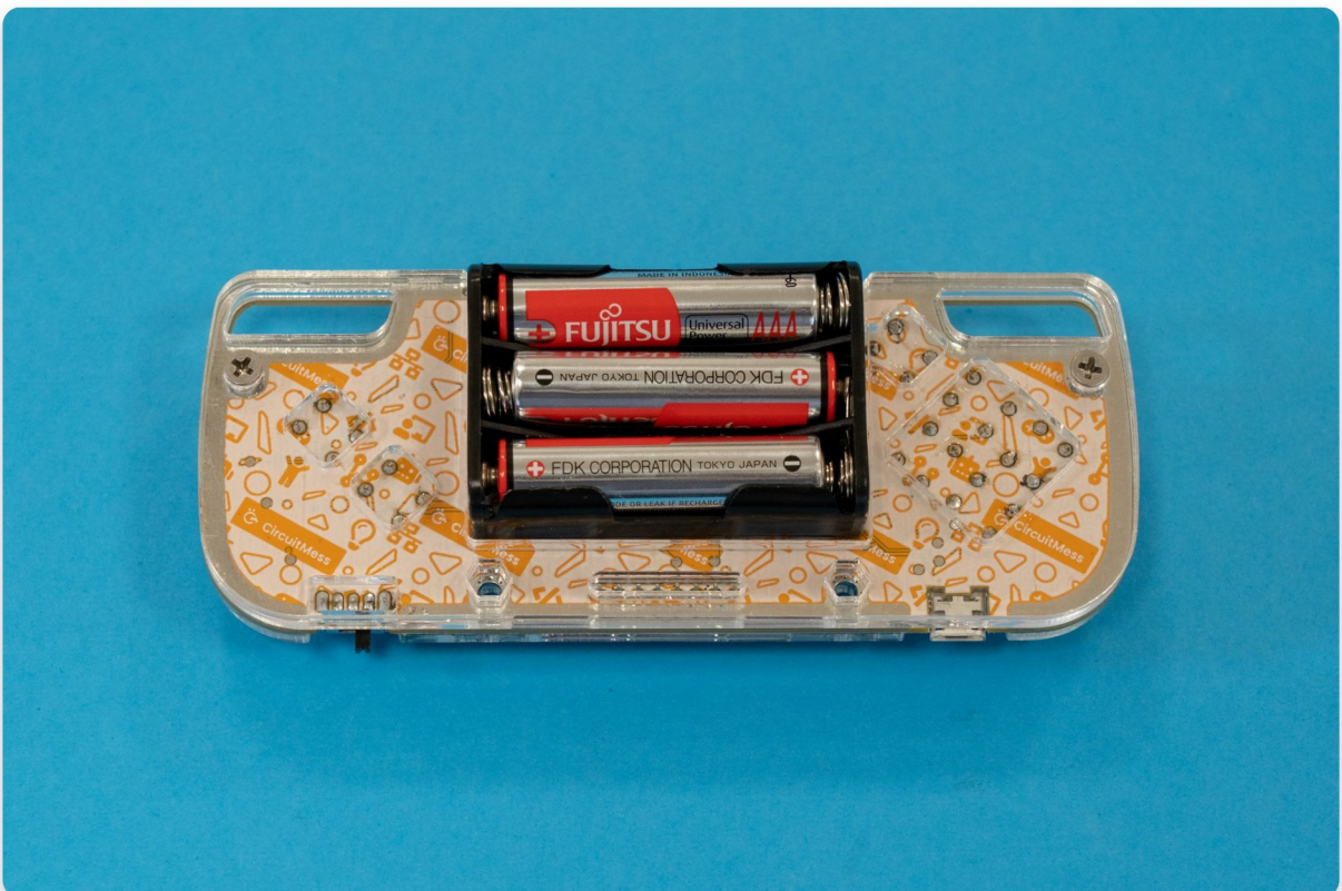
Zowel bouten als afstandhouders geplaatst en vastgedraaid vanaf de achterkant
