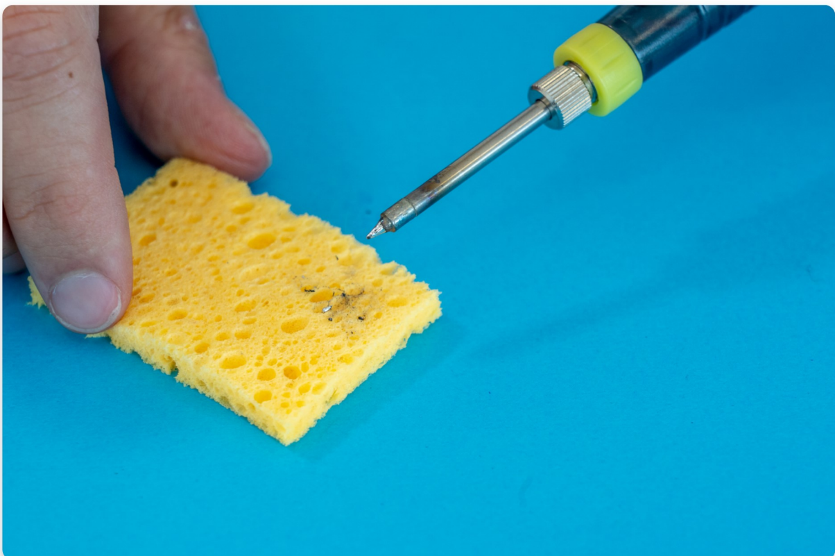
De punt van de soldeerbout reinigen
