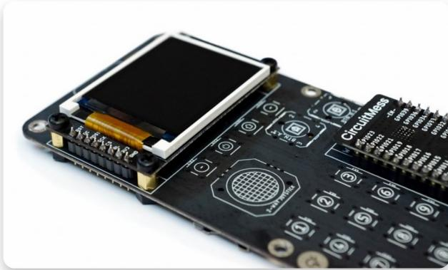
Platzieren Sie die Anzeigetafel auf der Hauptplatine dort, wo "LCD display" steht.
