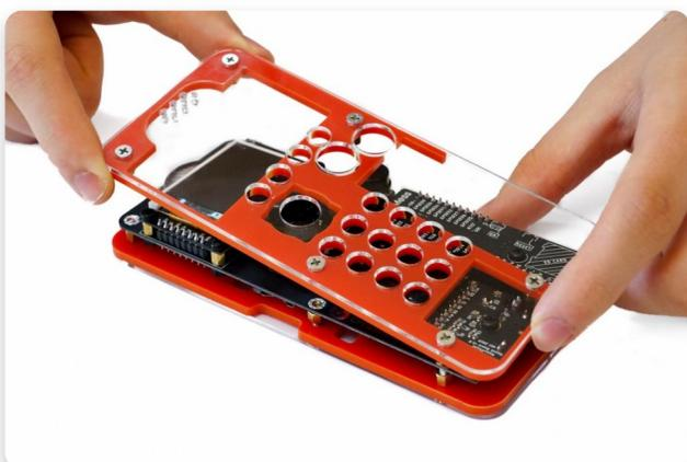
Setzen Sie nun das vordere Gehäuse auf die Vorderseite der Hauptplatine.
