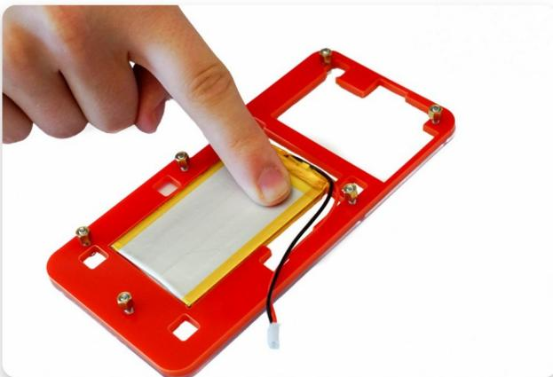
Legen Sie es in den größten Schlitz auf der Rückseite des Gehäuses und achten Sie darauf, dass das Kabel der Batterie richtig herum liegt.
