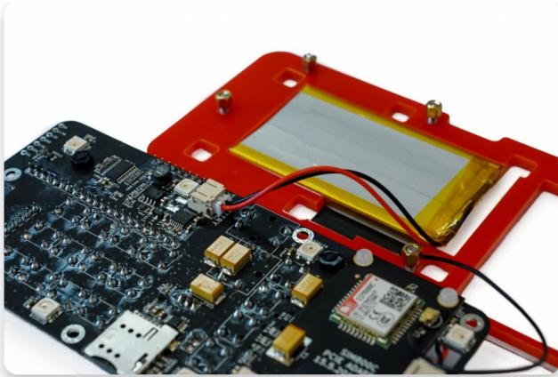
Nun sollten Sie das hintere Gehäuse mit der Hauptplatine mit der Batterie und der Antenne verbunden haben, wie auf dem Foto links zu sehen ist.
