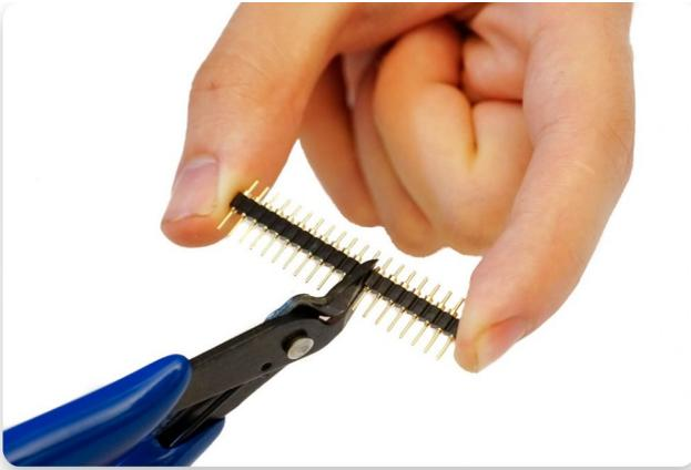
Auch hier müssen Sie die Stiftleisten auf die entsprechende Größe zuschneiden, damit sie auf die Pins auf der Anzeigetafel passen.
