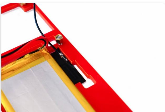
Dann kleben Sie ihn mit dem Antennendraht nach oben an das Gehäuse direkt neben der Batterie.
