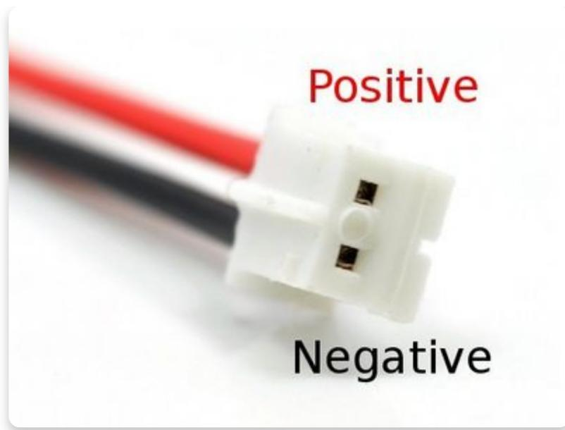
JST-Kabel, das die Batterie verbindet
