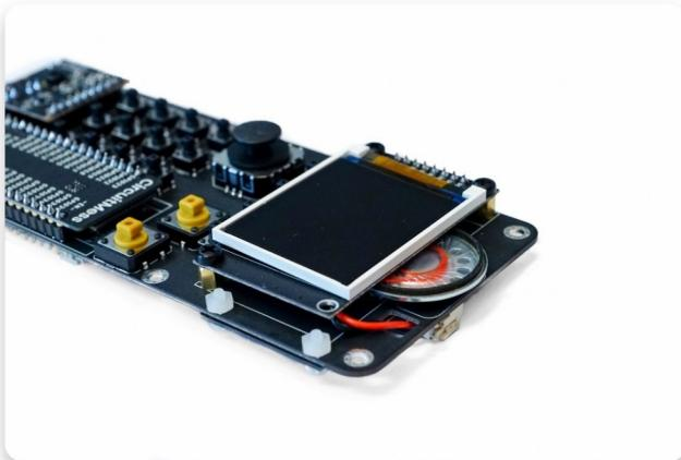
Platzieren Sie nun den Lautsprecher so, dass er genau zwischen die Anzeigetafel und die Hauptplatine passt.
