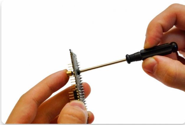
Stecken Sie den Bolzen so durch das Brain-Board, dass er in Richtung der Stifte zeigt.
