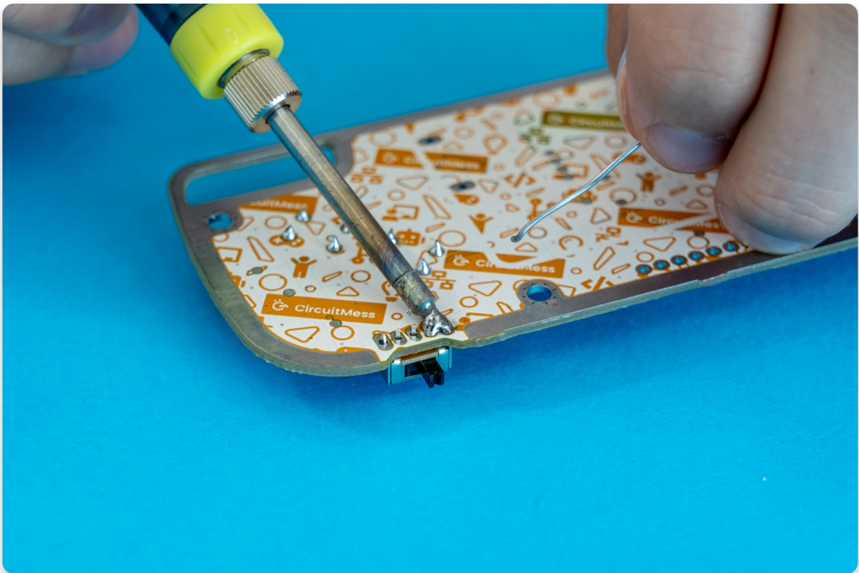
Primjer spajanja lemnih kontakata - ovo trebamo izbjeći!
