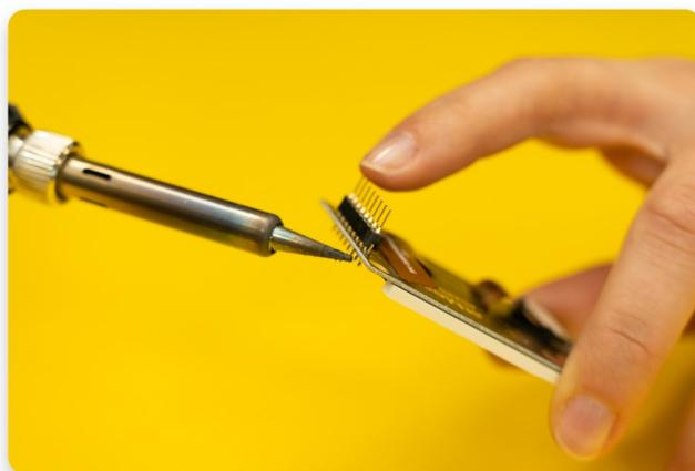
Regola il set di pin fondendo la saldatura sul primo pin
