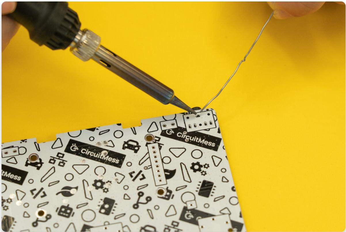
Capovolgì il circuito stampato e preparati a saldare il primo componente
