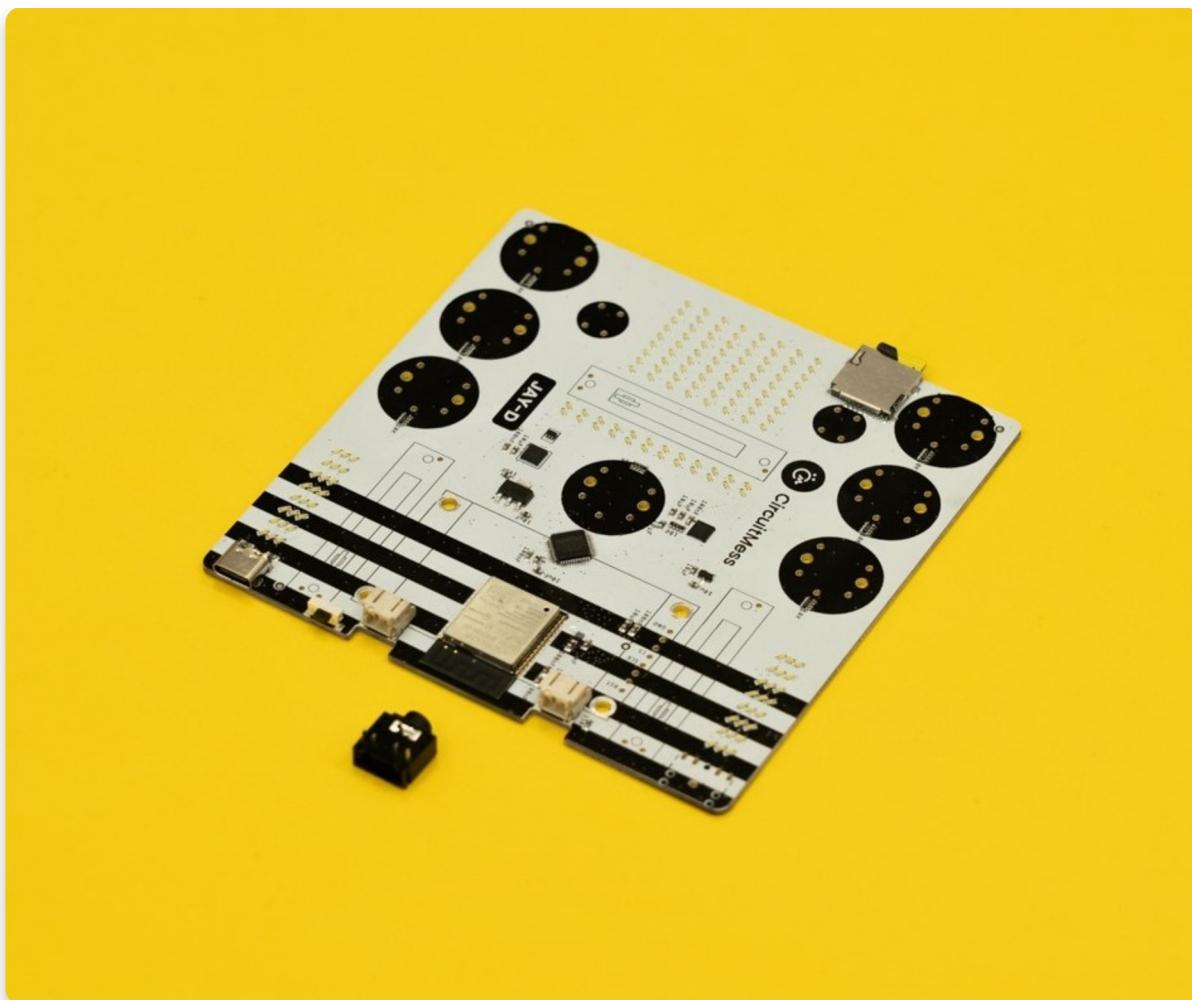
È importante saldare questo componente nel posto giusto. Assicurati di avere il circuito rivolto verso l'alto, come mostrato nelle foto. Una volta trovato il posto per i pin del jack delle cuffie nell'angolo della scheda (dove ci sono le strisce bianche e nere) regola il componente in modo che si inserisca completamente.
