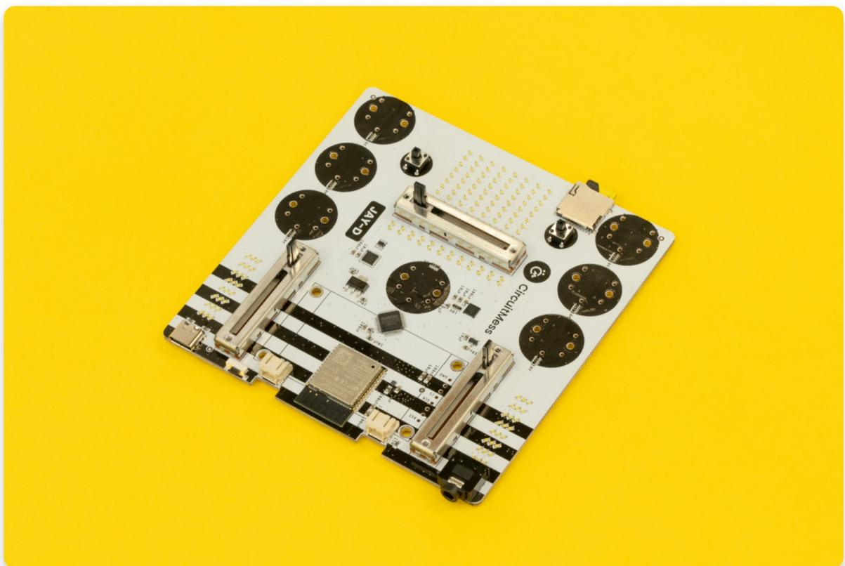
Potenzimetri saldati alla scheda dalla parte anteriore
