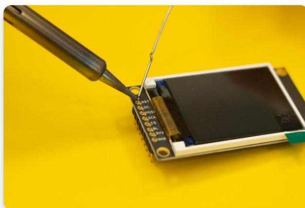
1) Salda solo il primo pin di una fila
