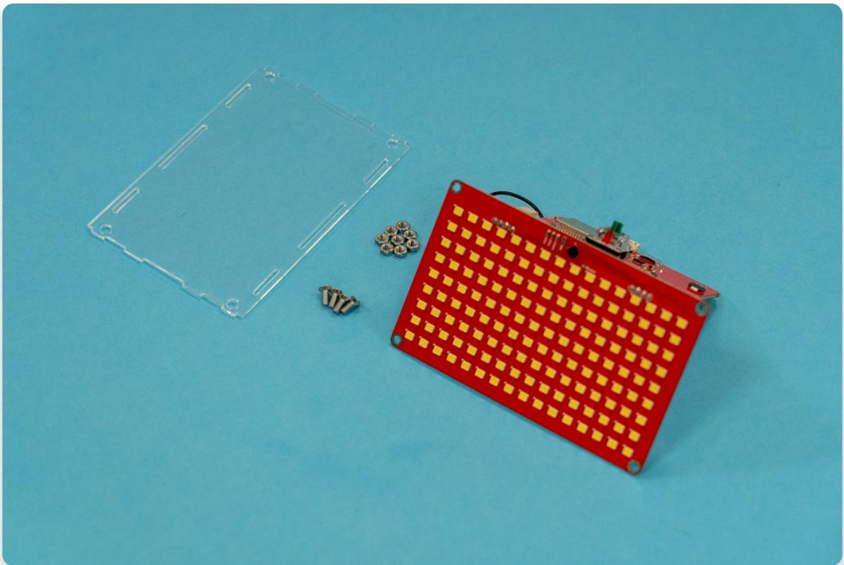
**Anzeigetafel, Metallbolzen, Abstandshalter und die richtige Gehäuselage**
