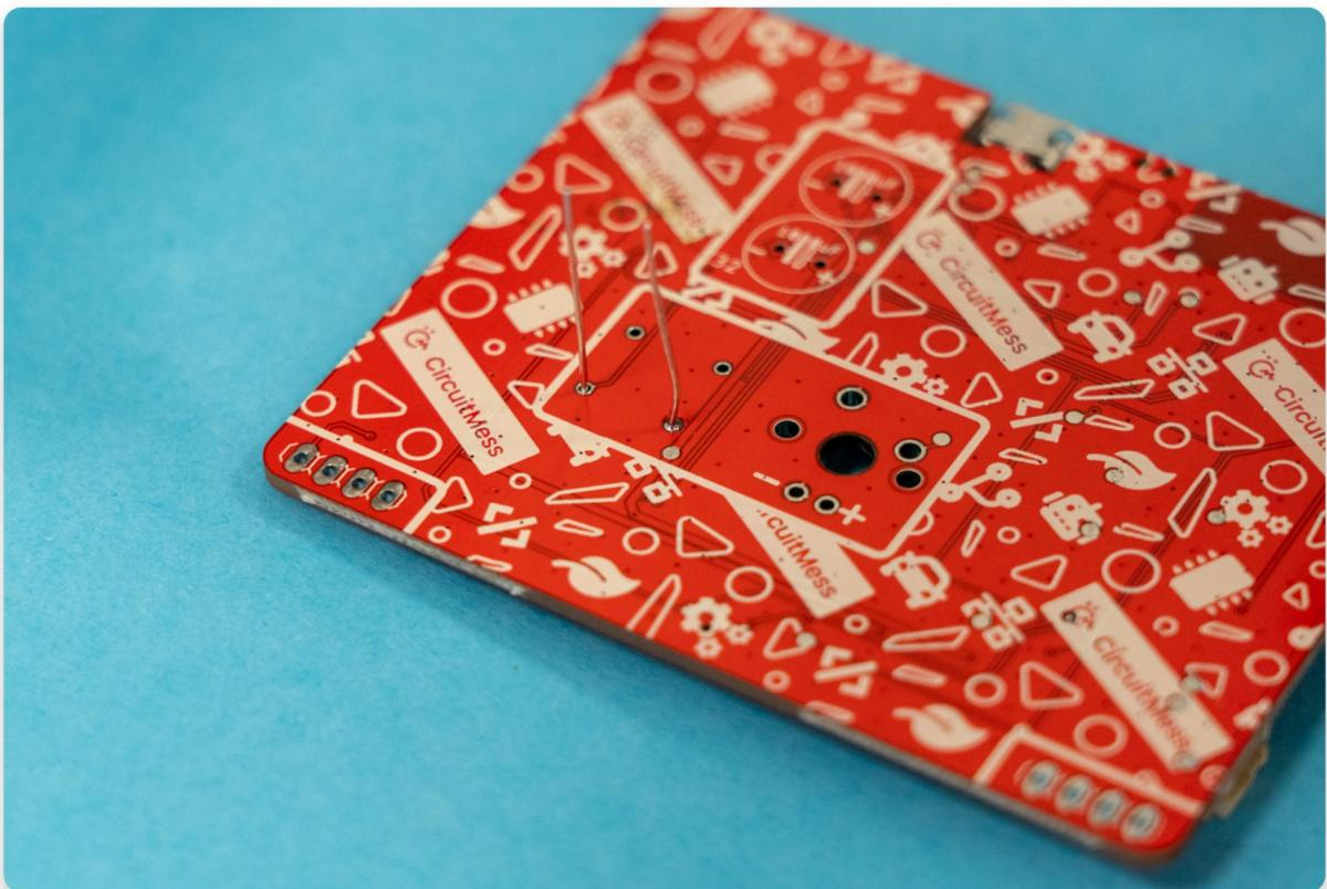
Schneiden Sie alle Leitungen der gelöteten Bauteile mit der Seitenschneiderzange ab.
