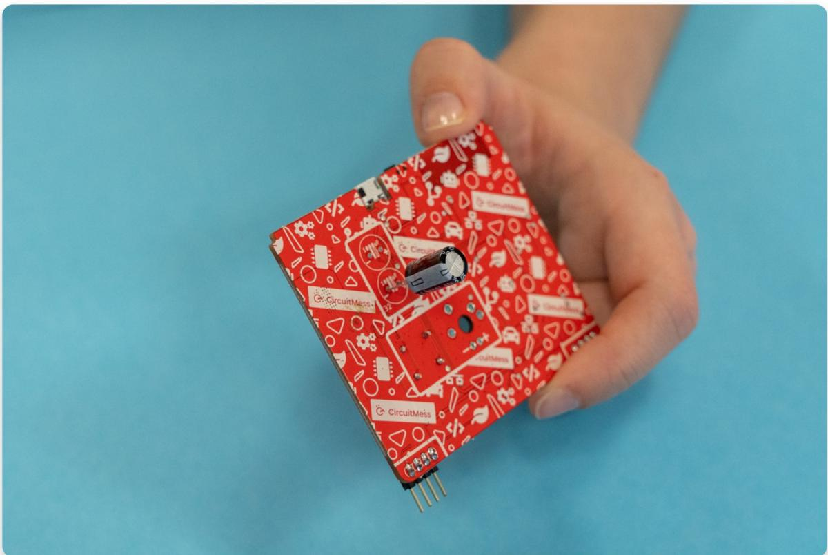
**Stimmen Sie die Polarität des Kondensators mit der auf der Platine markierten Polarität ab. Richten Sie die Polarität des Kondensators an der Polaritätsmarkierung auf der Platine aus.**
