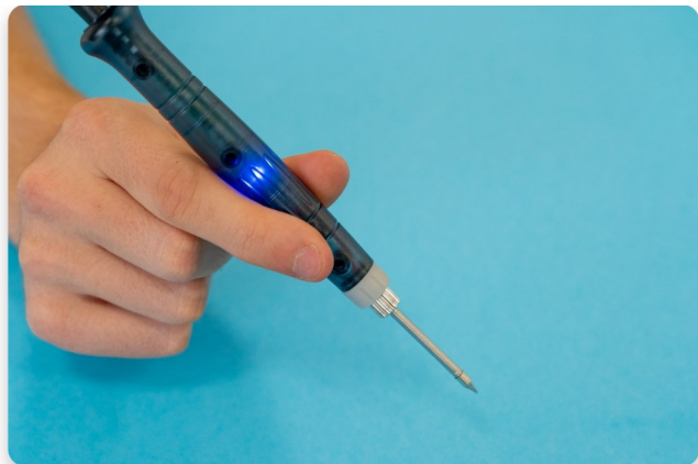
Das blaue Licht bedeutet, dass der LötKolben eingeschaltet ist
