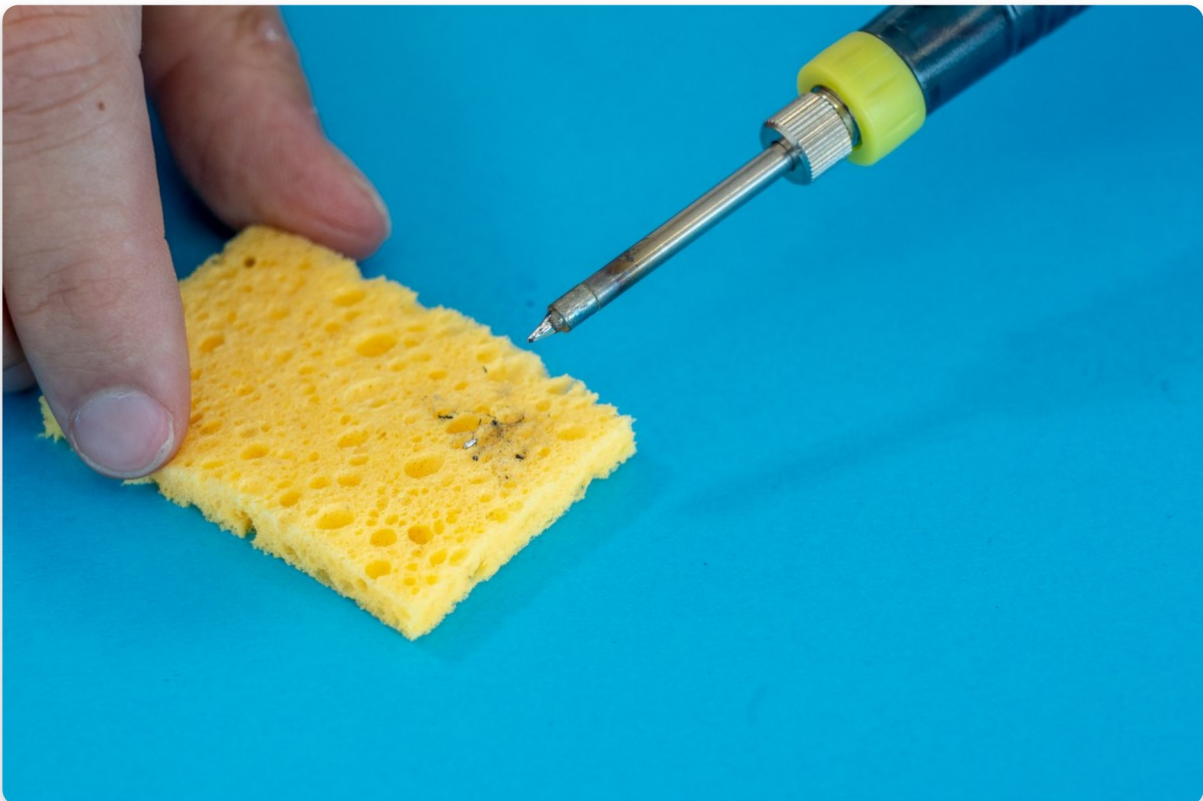
Reinigung der Spitze des LötKolbens
