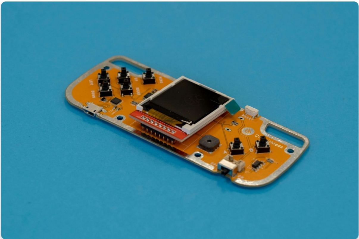
Der Bildschirm kommt in die mittleren Pins der Konsole
