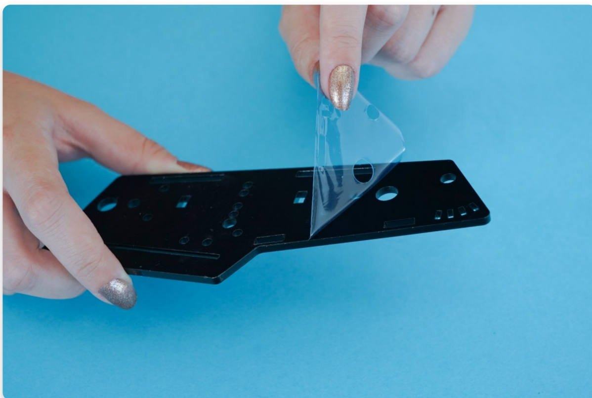
Togli lo strato protettivo da entrambi i lati di tutti i pannelli della custodia.
