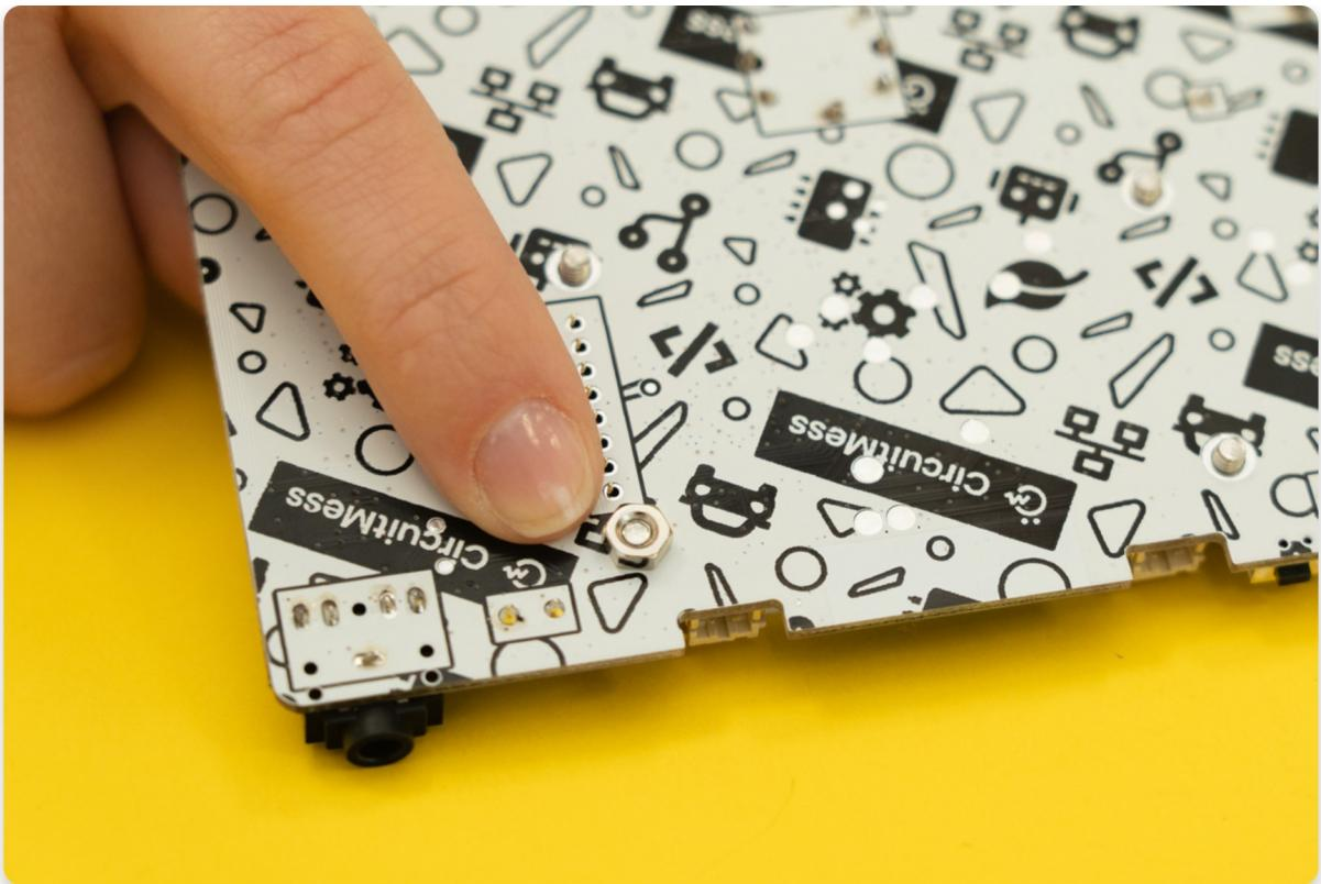
Serrez l'écrou pour qu'il maintienne l'écran en place
