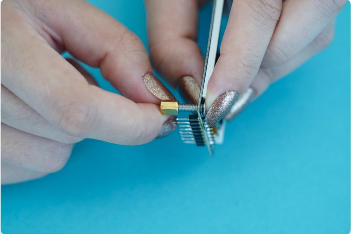
**Gire el espaciador de latón en el extremo del tornillo de metal**
