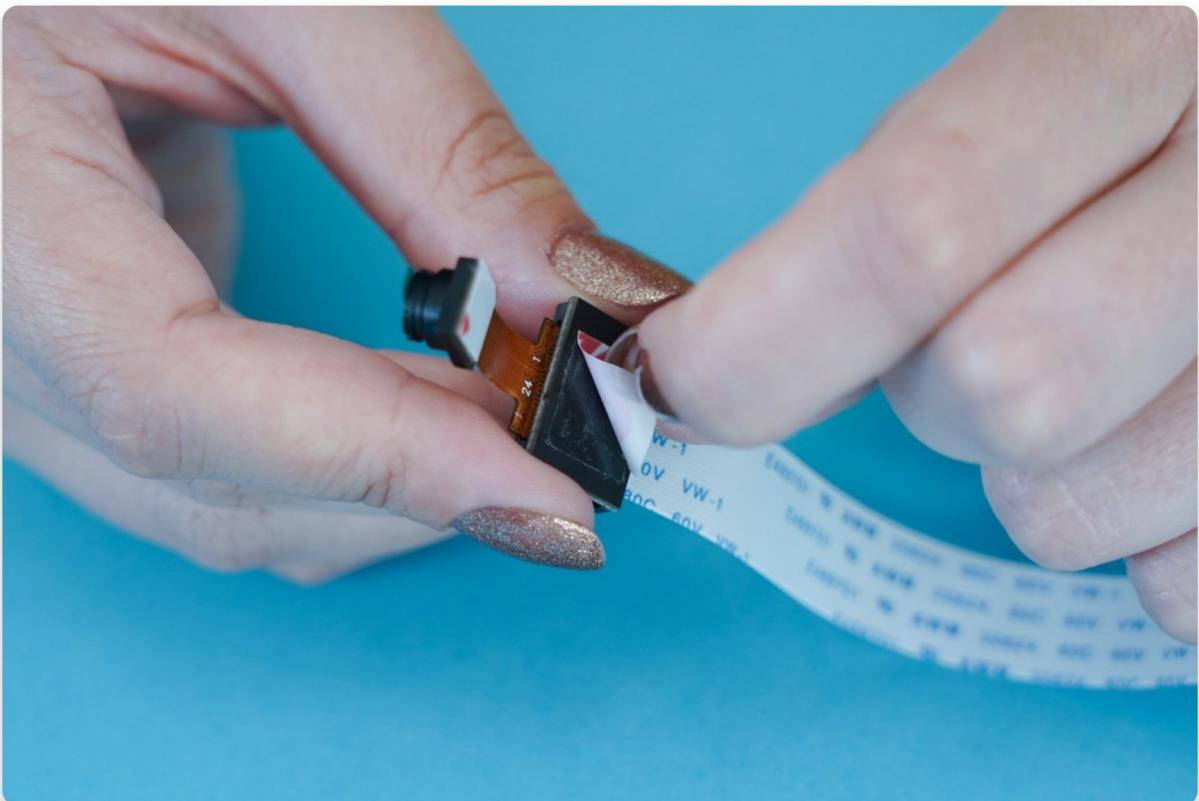
Toma la cámara y el tablero de los faros y gire al revés. Luego, pega el tablero de cámara pequeño en la parte más corta de la cámara y el tablero de faros, como se muestra en la foto:
