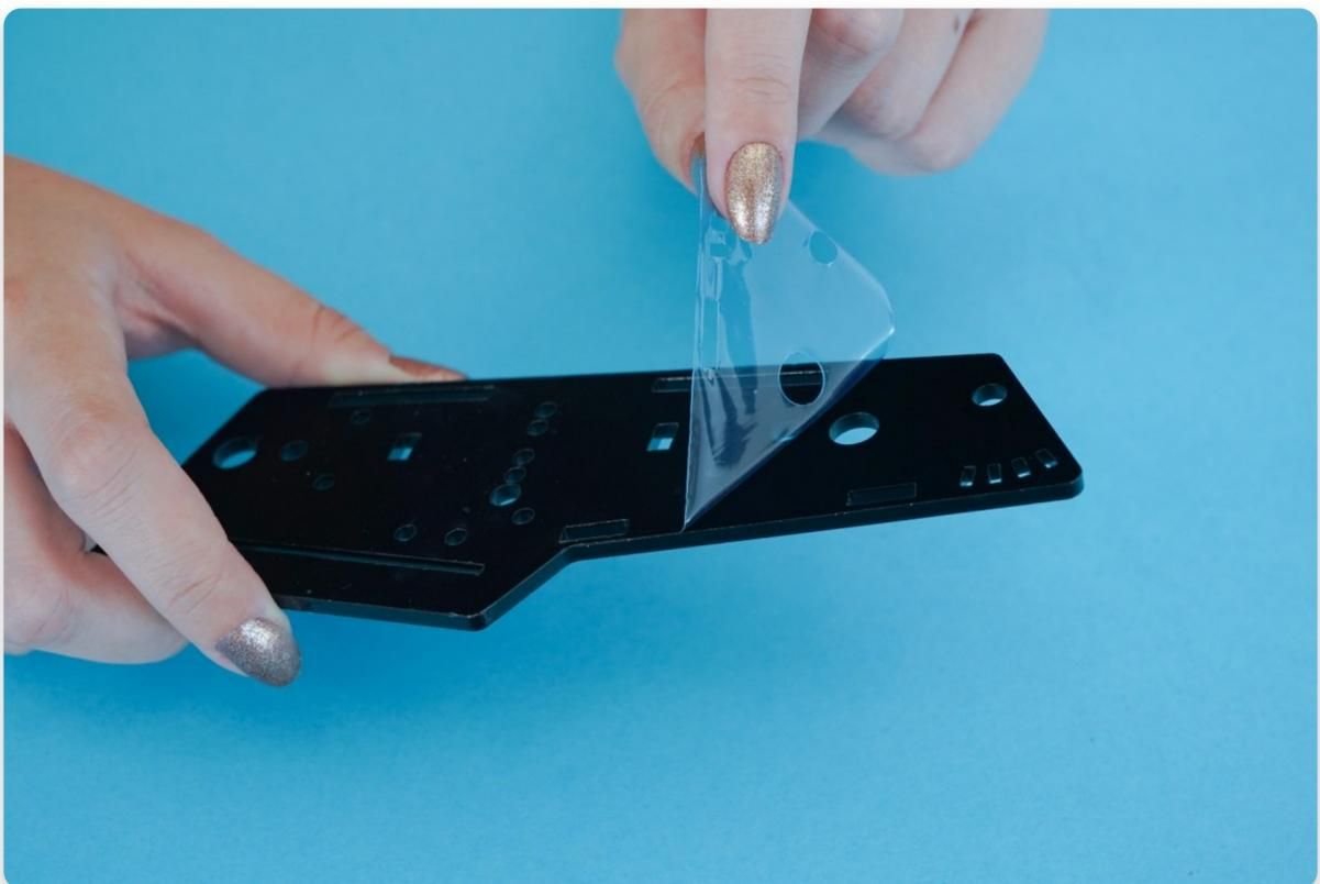
Desprenda la cubierta protectora de ambos lados de todos los paneles de la carcasa.
