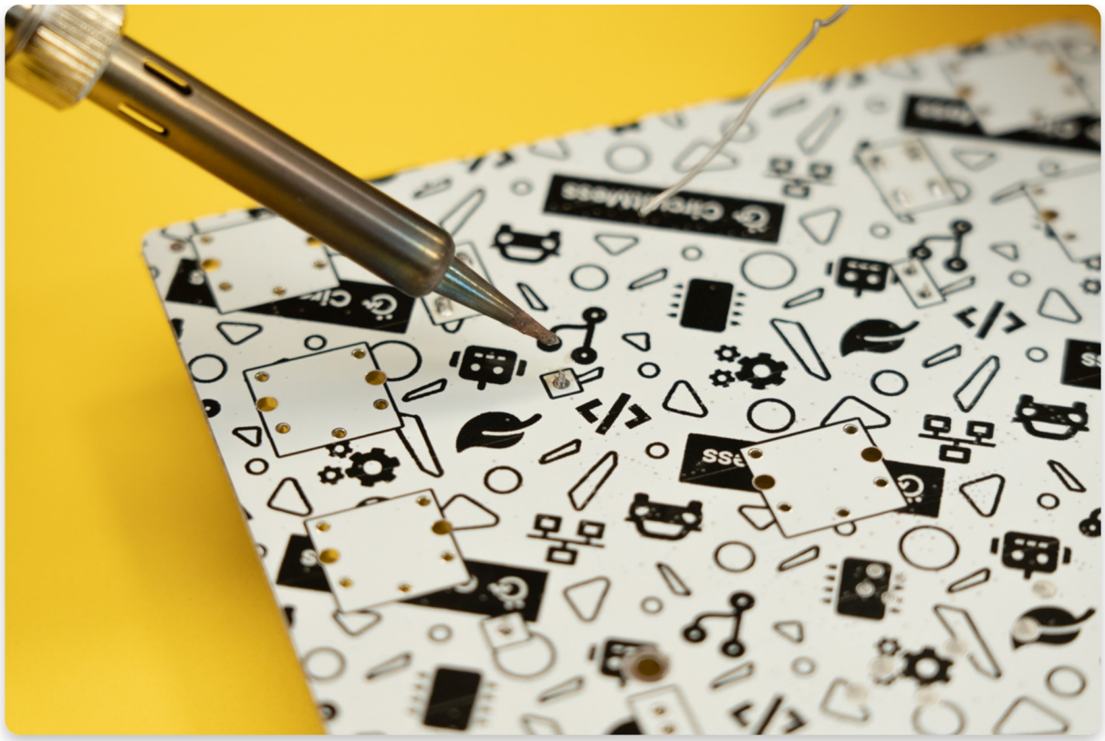
Soldadura del primer pin
