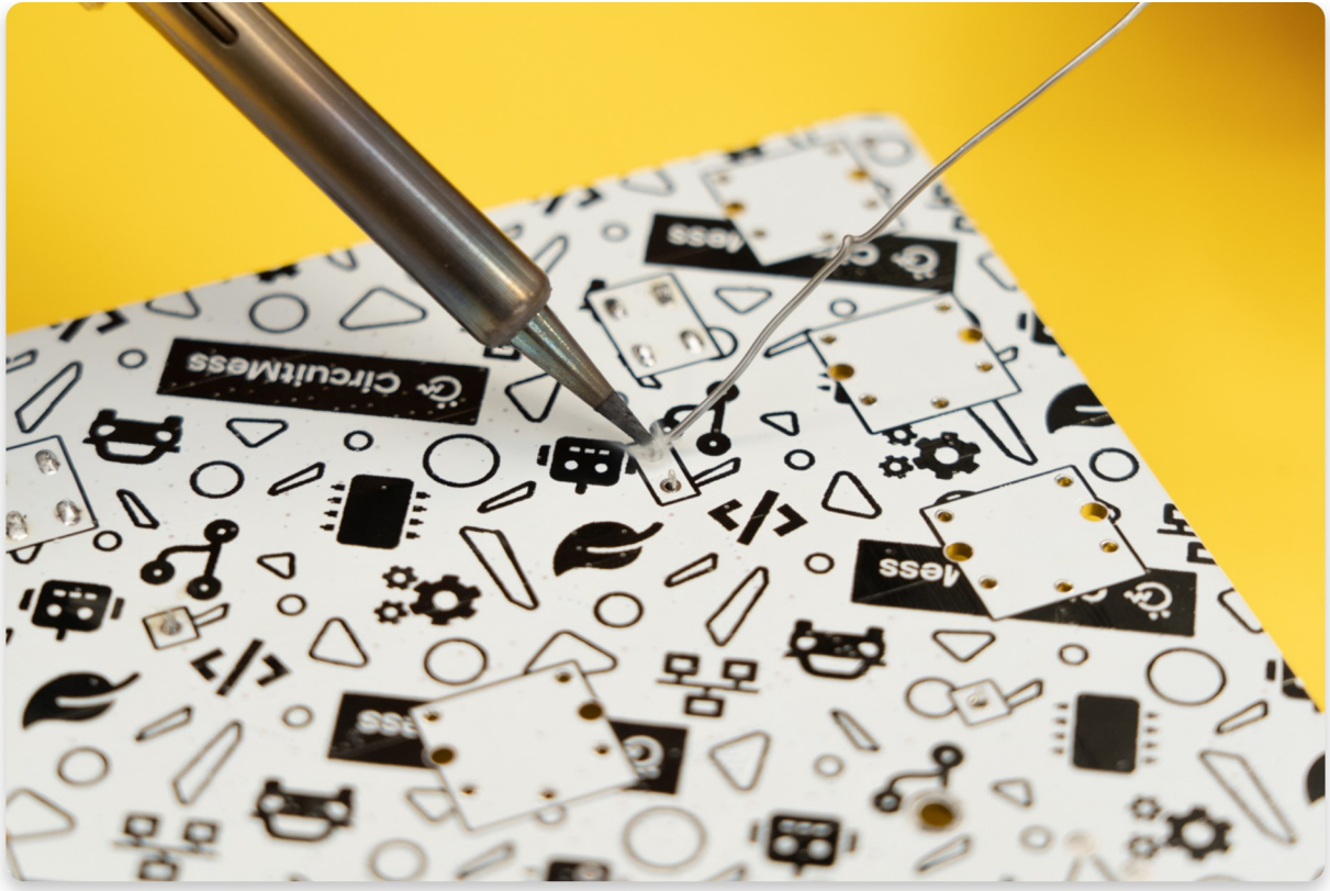
Soldadura de los dos pines
