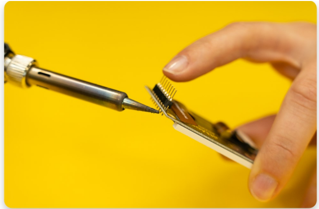
Ajuste el cabezal fundiendo la soldadura del primer pin
