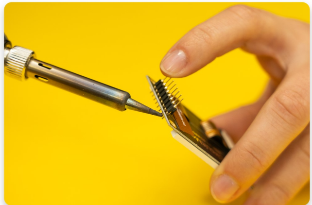
Repita el paso si es necesario hasta que el cabezal esté perpendicular a la tarjeta
