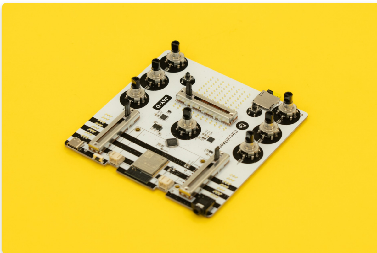
Insertar todos los codificadores giratorios
