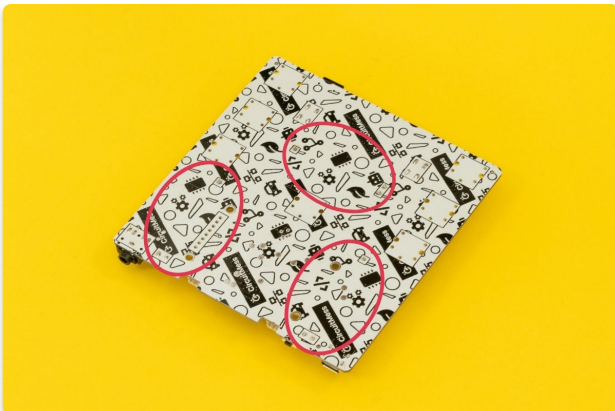
Sliders soldados a la tarjeta, vista posterior
