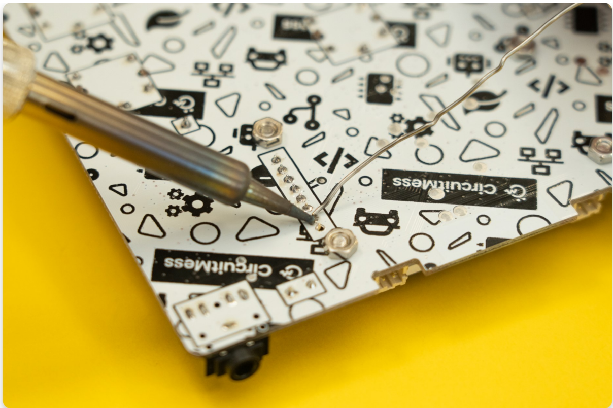
Soldar los pines que conectan la pantalla
