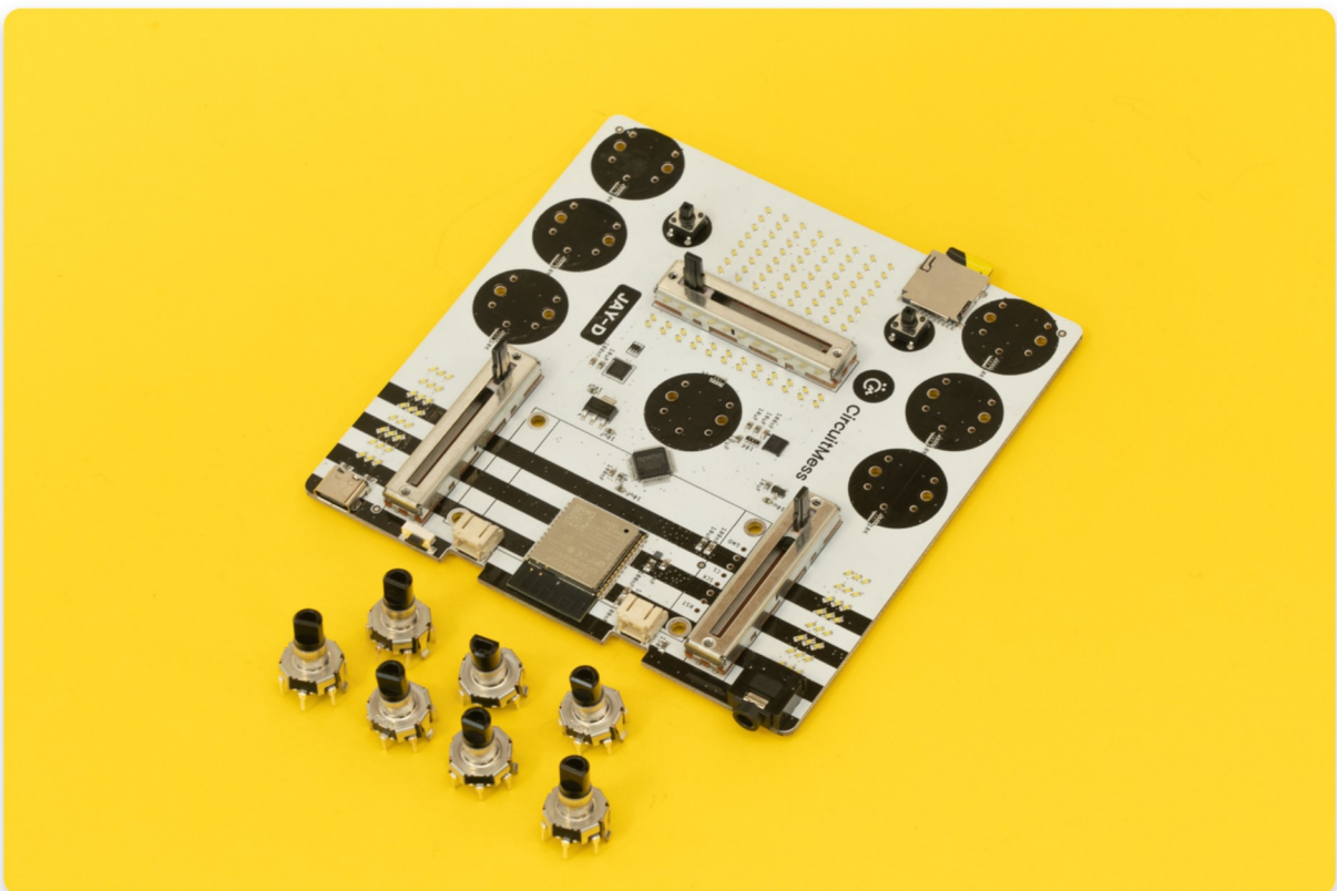
Onderdelen die je nodig zal hebben: 7 roterende encoders + printplaat
