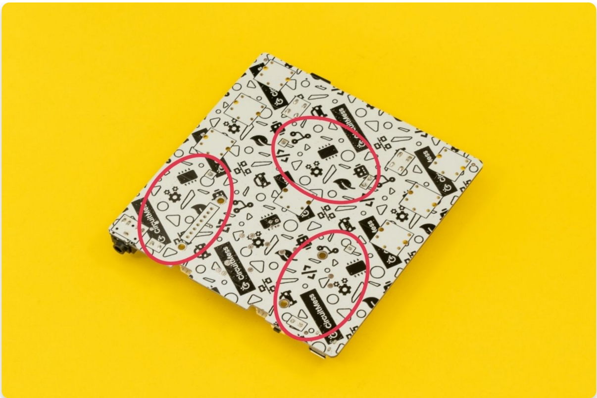
Schuifregelaars gesoldeerd aan de printplaat van achteren bekeken
