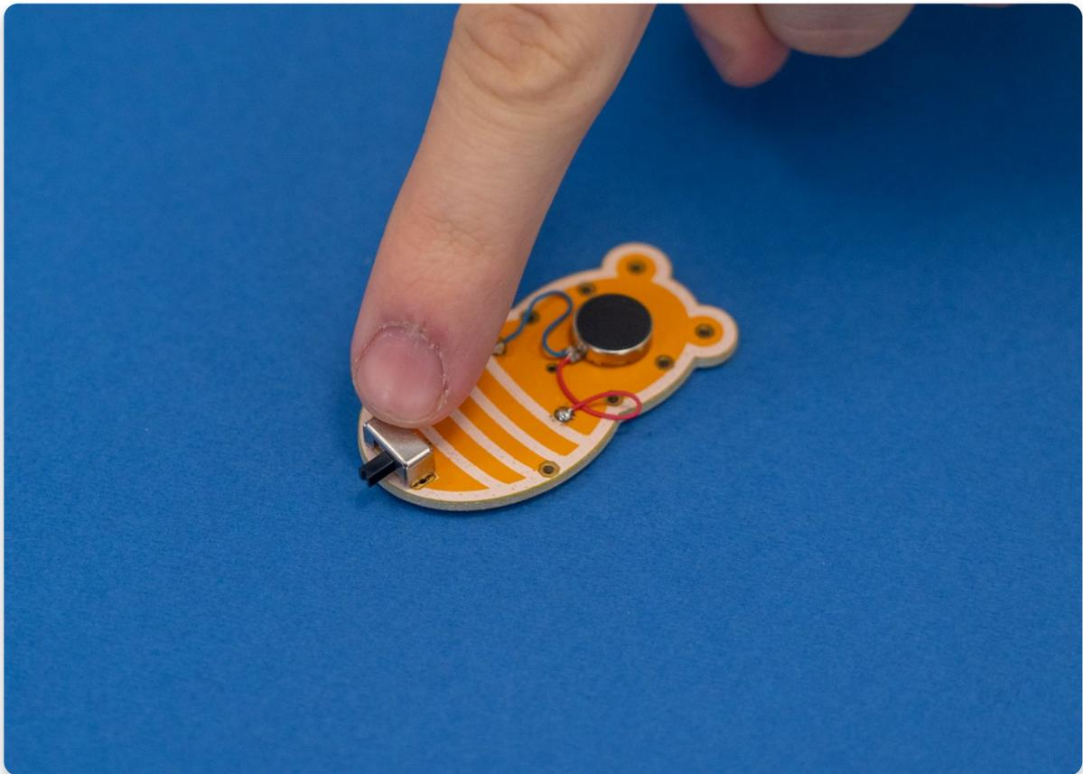
Jetzt ist es an der Zeit, den **Schalter an die Platine zu löten**. Vergewissere dich vorher, dass der Schalter senkrecht auf der Platine steht.
