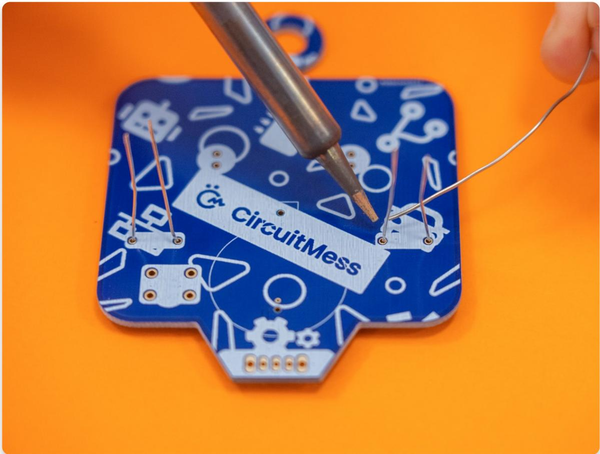
Nachdem du alle Widerstände verlötet hast, **sieh dir die Lötstellen noch einmal an**, um sicherzustellen, dass es keine kalten Lötstellen gibt.
