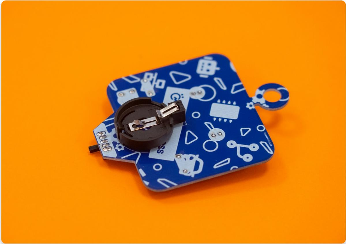
Drehe MARV um und löte die beiden Stifte des Batteriehalters an.
