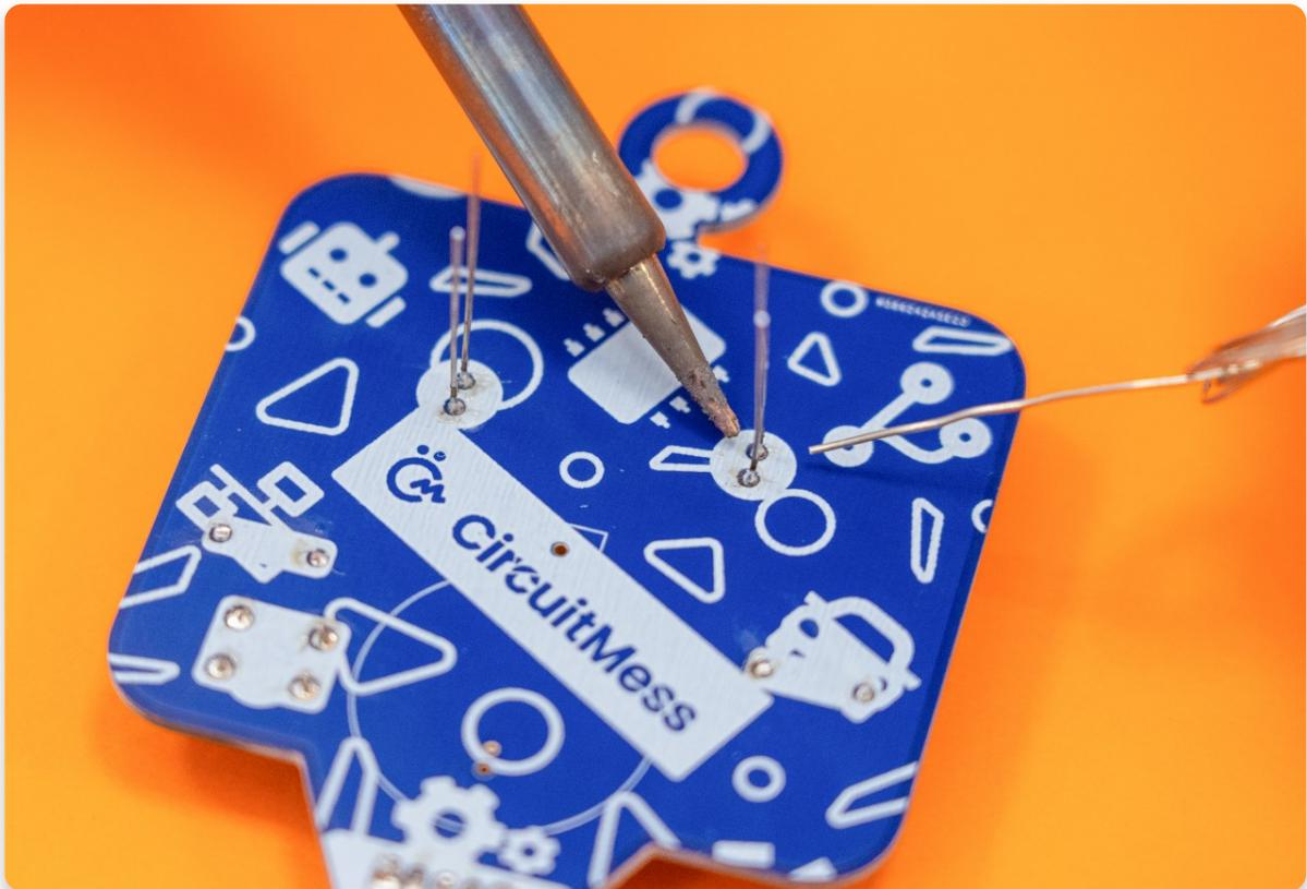
Nachdem du dich vergewissert hast, dass es keine Überbrückungen zwischen den Lötstellen gibt, nimm deine Zange und schneide den Rest der LED-Beine, den wir nicht mehr benötigen, ab.
