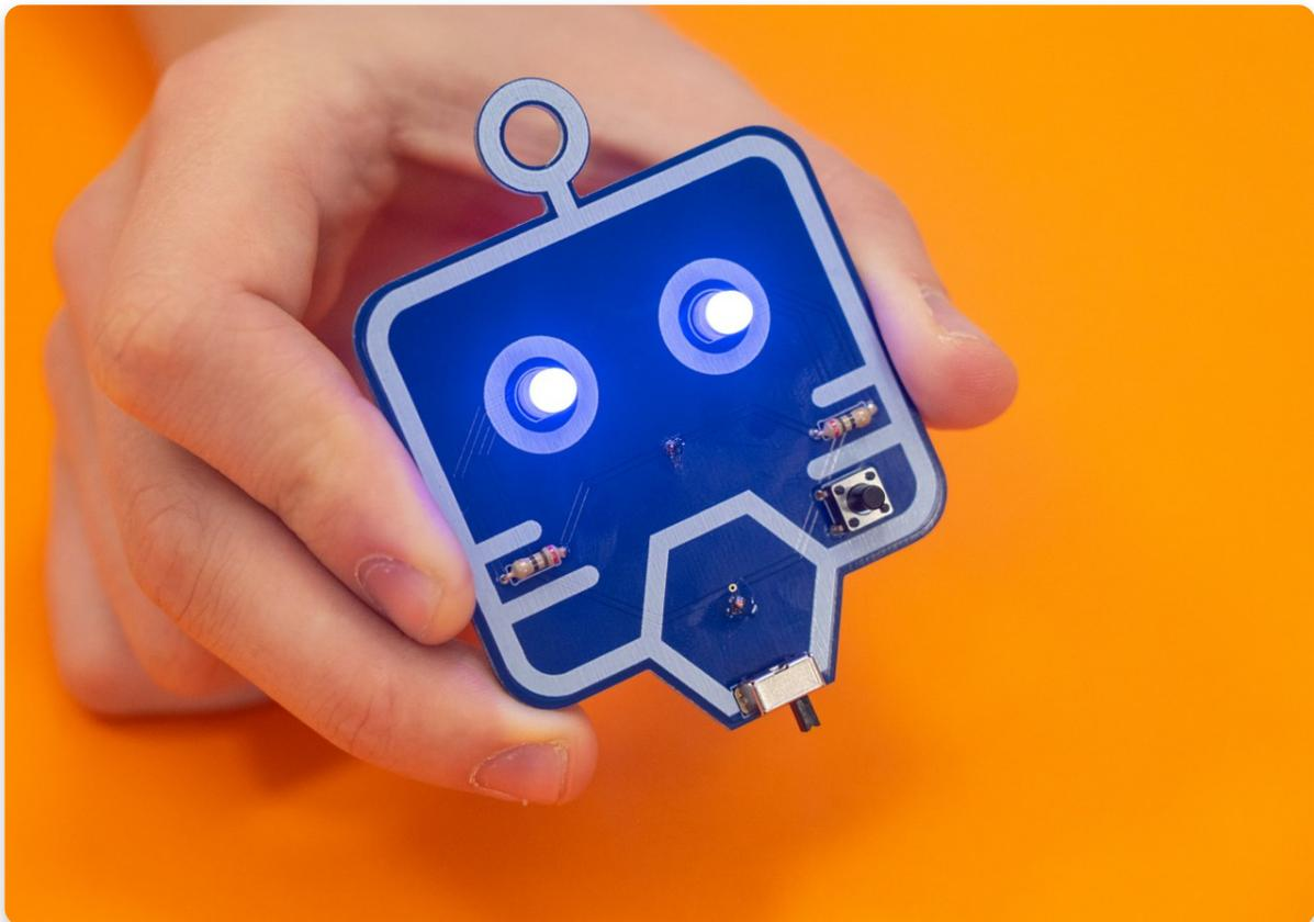
MARV ist ein auch für Anfänger geeigneter **12-teiliger Bausatz**, mit dem du etwas **über das Löten und den Unterschied zwischen einem Taster und einem Schalter** lernen kannst.
