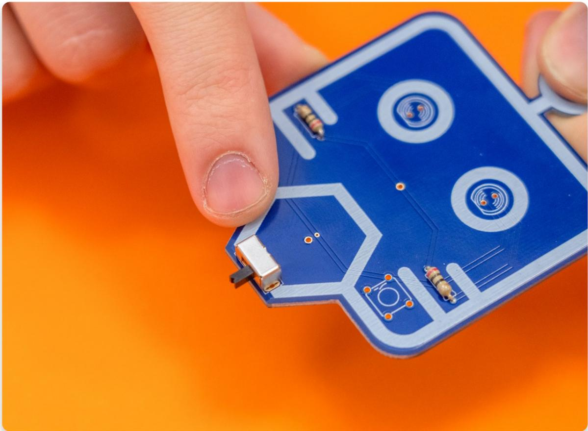
Jetzt ist es an der Zeit, den **Schalter an die Platine zu löten**. Vergewissere dich vorher, dass der Schalter senkrecht auf der Platine steht.
