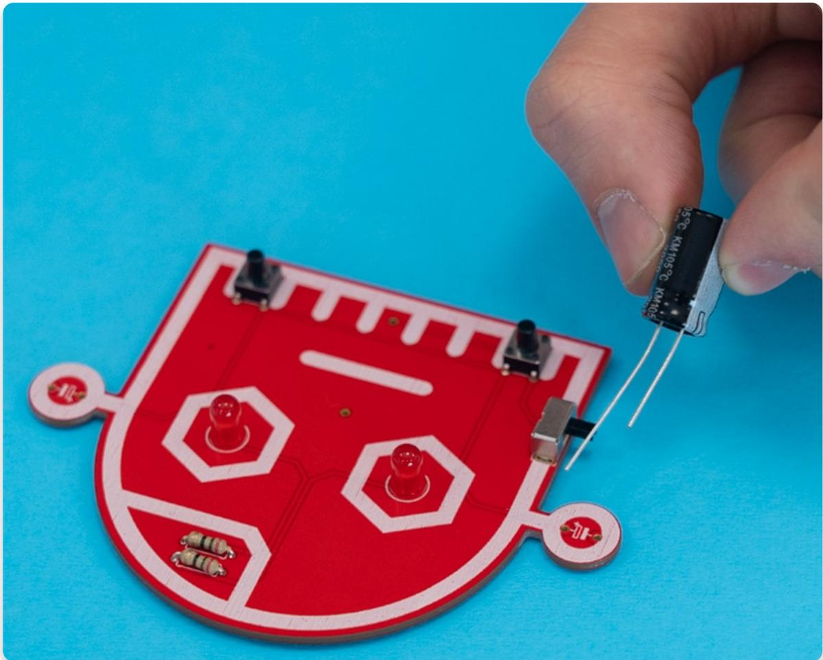
Nimm deinen LötKolben und löte die Beine der Kondensatoren an die Platine.
