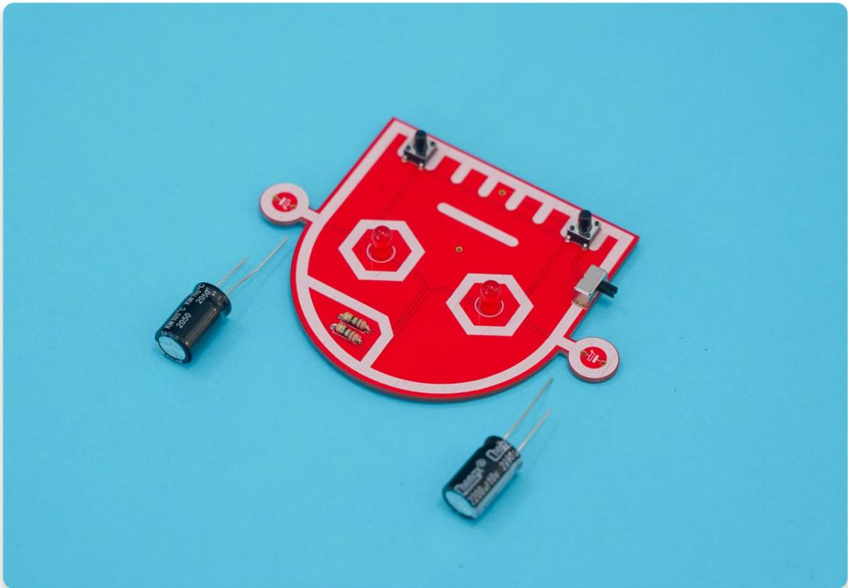
Die Kondensatoren werden in CAPACITRONS Ohren gesteckt.
