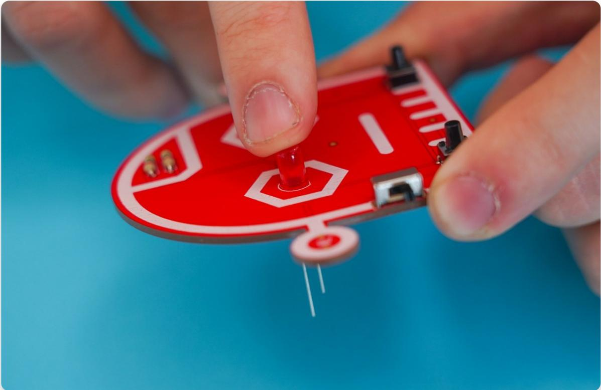
Dreh deinen CAPACITRON um und löte die LEDs ein.
