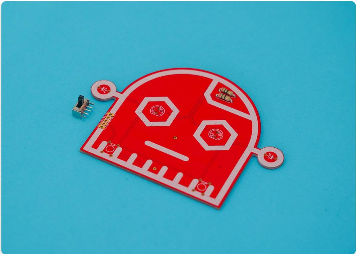
Platziere den Schalter auf der Vorderseite von CAPACITRONs Kopf.
