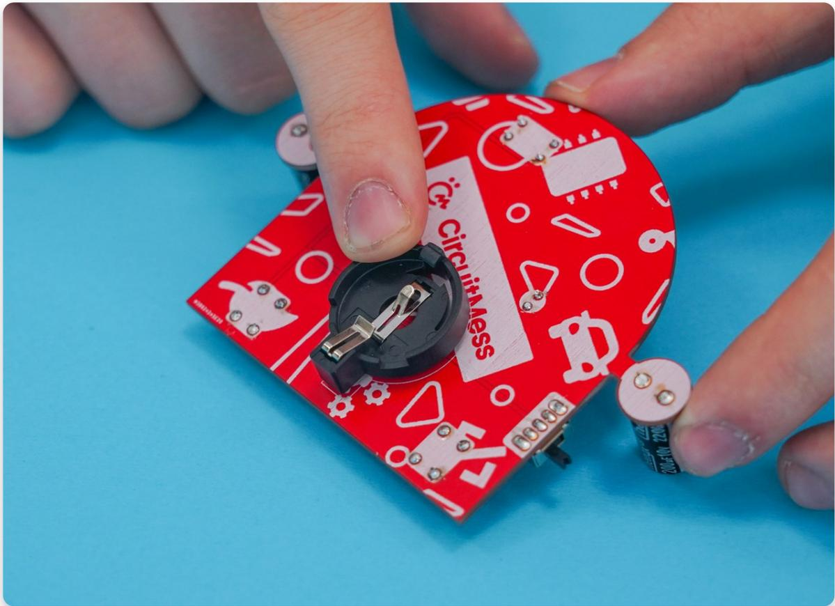
Drehe CAPACITRON um und löte die beiden Stifte des Batteriehalters an.
