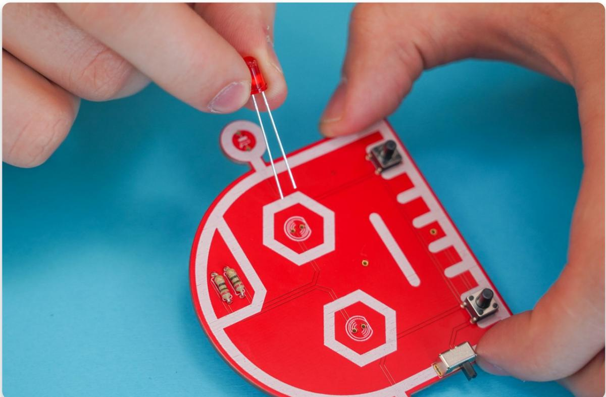
Wir müssen auf die Polarität der LEDs achten, sonst werden sie nicht funktionieren.
