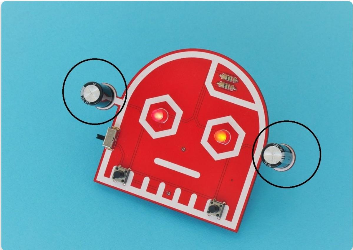
Ein Kondensator kann Energie aus einem Schaltkreis aufnehmen und vorübergehend speichern. Zu einem späteren Zeitpunkt kann diese gespeicherte Energie wieder an den elektronischen Schaltkreis abgegeben werden.
