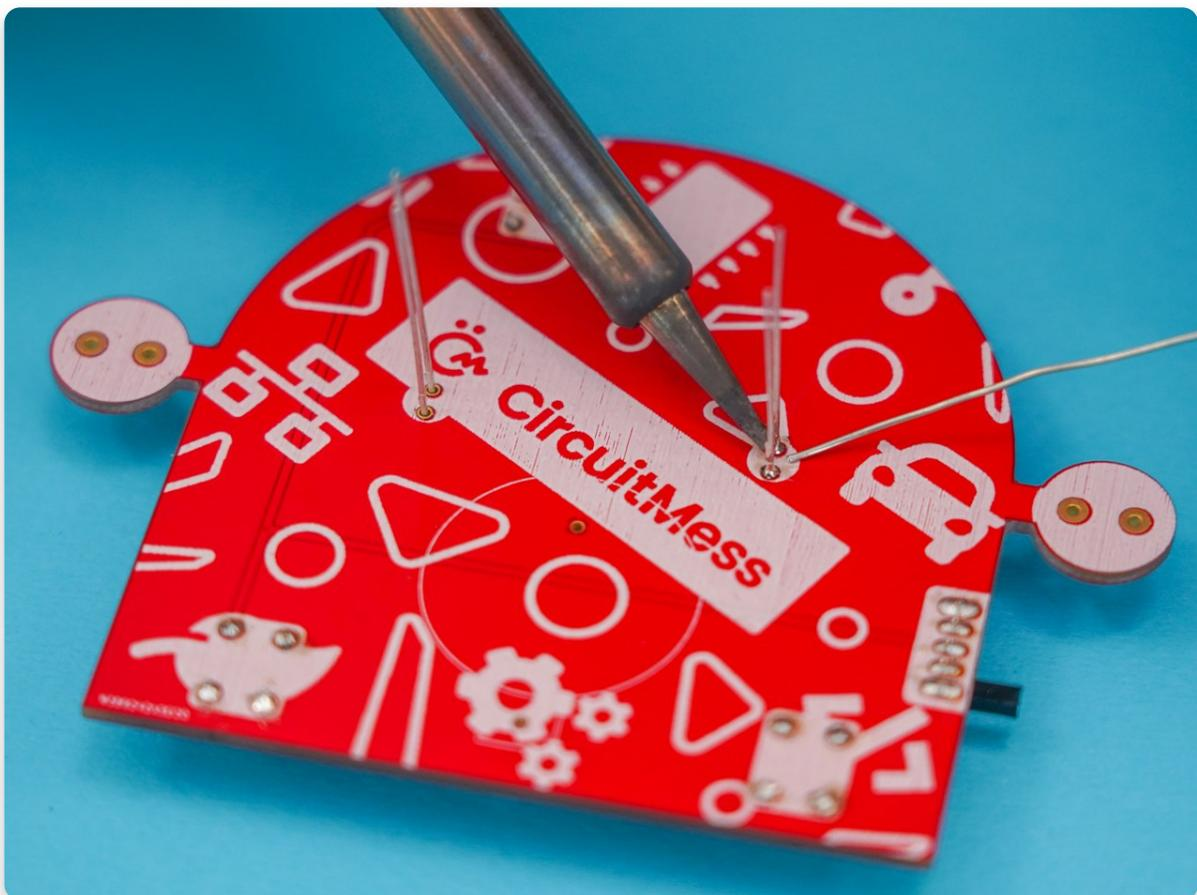
Nachdem du dich vergewissert hast, dass es keine Überbrückungen zwischen den Lötstellen gibt, nimm deine Zange und schneide den Rest der LED-Beine, den wir nicht mehr benötigen, ab.
