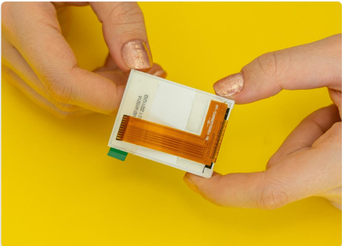
Nimm nun das große Gehäuse und stecke das orangefarbene Anschlusskabel, das mit dem Bildschirm verbunden ist, durch das Gehäuse, wie auf dem Foto unten
