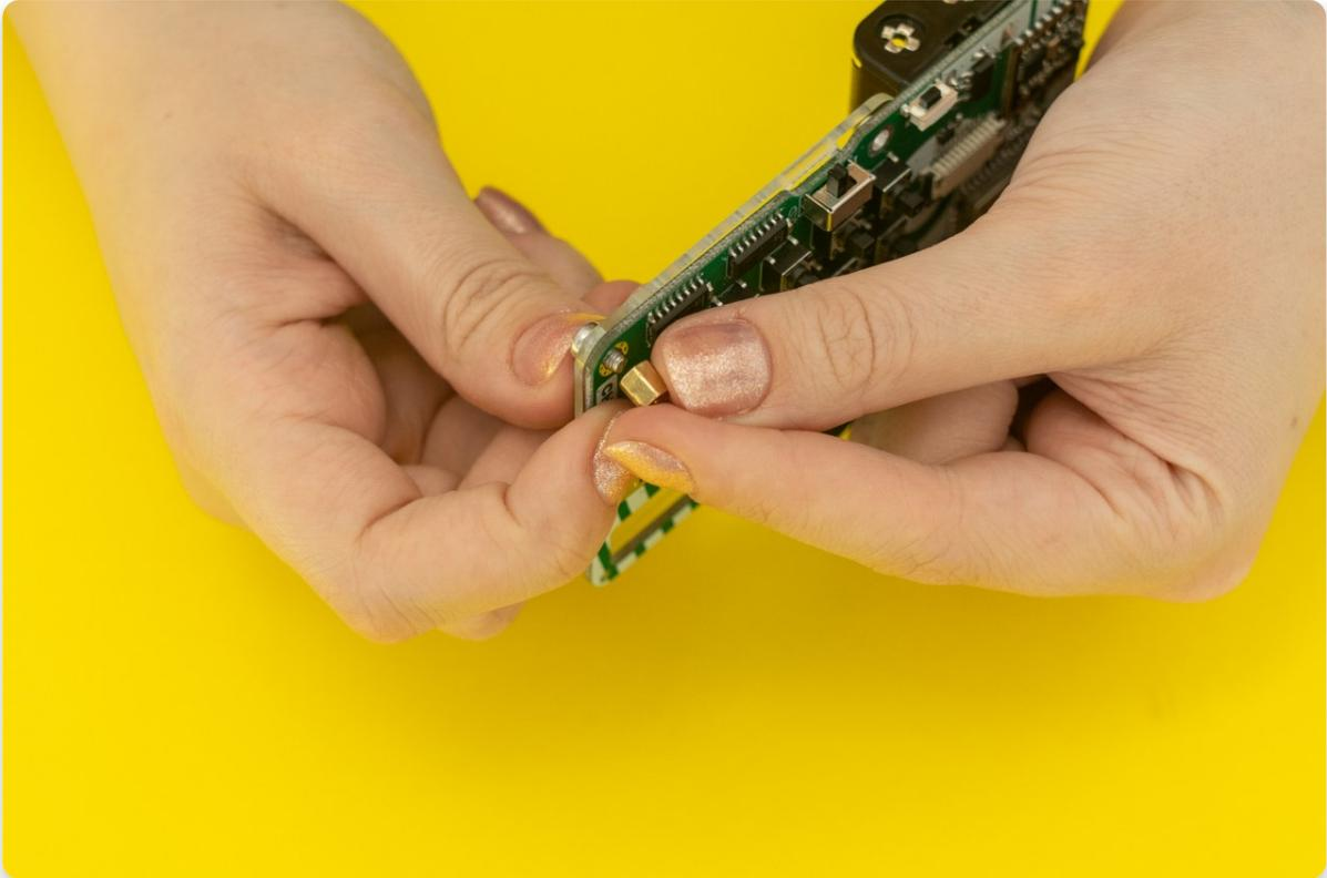
Sobald sie verbunden sind, nimm einen Schraubenzieher und ziehe jede kleinen Schraube an, um die Gehäuserückseite an der Leiterplatte zu befestigen.
