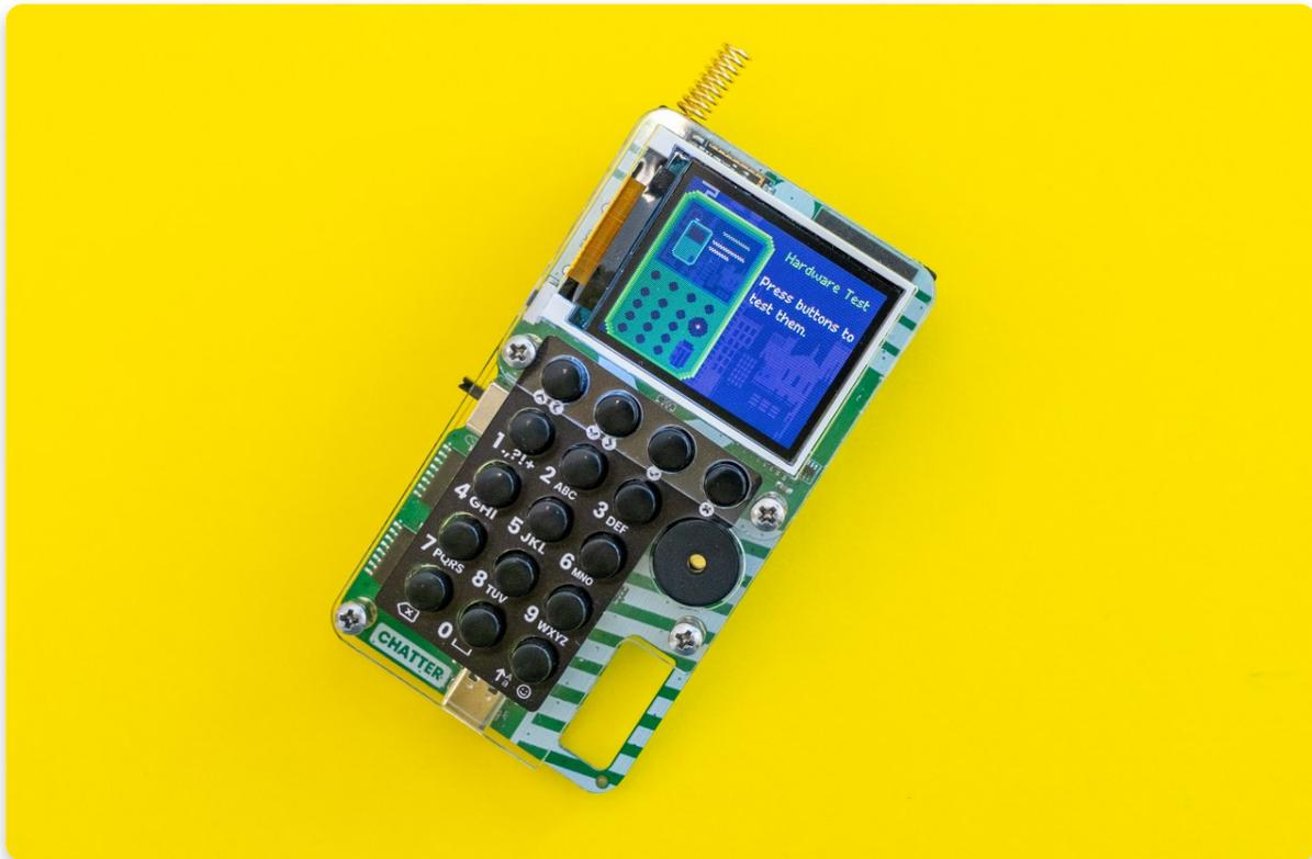
Du solltest alle sechzehn Tasten deines Chatters, die du angelötet hast, mindestens ein Mal drücken. Wenn die Taste richtig funktioniert, sollte der Kreis, der diese Taste darstellt, grün werden. Wenn einer der Kreise nicht grün wird, funktioniert diese Taste nicht. In diesem Fall solltest du die Lötstellen der entsprechenden Taste überprüfen.
